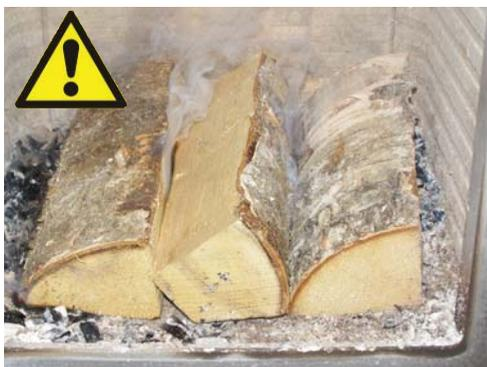
Hier ist etwas Holz auf eine zu geringe Glutschicht gelegt worden und es wird zu wenig Luft zugeführt – die Rauchentwicklung beginnt.
