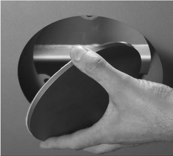
Entfernen Sie Rauchschikane, Rauchwendeplatte und Abdeckplatte. Blinddeckel (3 Stück M6-Muttern) und Dichtung werden abgenommen.
