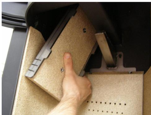
Entfernen Sie Schmutz und Staub und setzen die Teile in umgekehrter Reihenfolge wieder ein.
