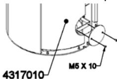
5. Assembler les plaques en pierre ollaire jusqu'au et avec l'anneau ① et les aligner. Les fixer devant sur le corps de poêle avec des vis à tête cylindrique (cf. Step 1 & 2).
