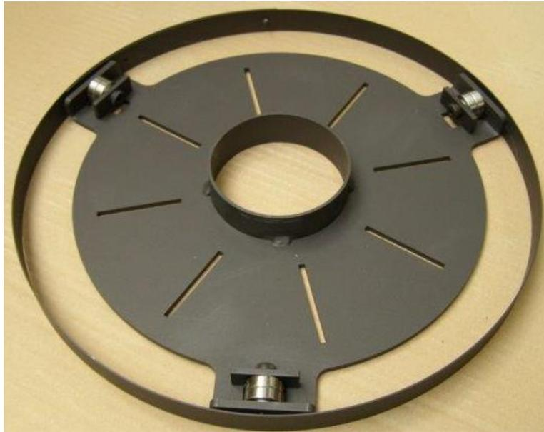
4. Placez l'anneau à l'extérieur de la base pivotante et serrez la vis dans l'anneau. Tournez l'anneau de couverture de sorte que la vis est située à côté de l'arrière de poêle. Vérifiez le fonctionnement du socle pivotant.
