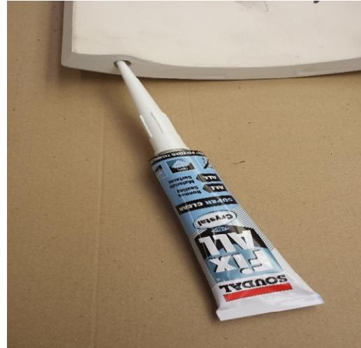
Die Löcher sind ca. 2 cm tief und müssen wie auf dem Bild rechts ca. 1/3 mit dem Leim gefüllt werden.
