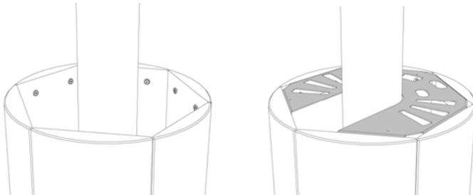
14. Si l'amenée d'air frais n'est pas branchée par derrière, la grille peut être montée sur l'orifice.
