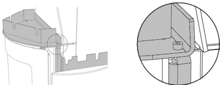
9. Avant de continuer avec le montage de DOM, les plaques en pierre ollaire déjà montées doivent être positionnées.
