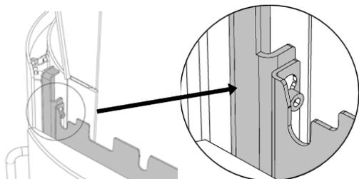
7. Soulever légèrement le recouvrement frontale pour régulateur de l'arrivée d'air frais ② lors de l'insertion.
