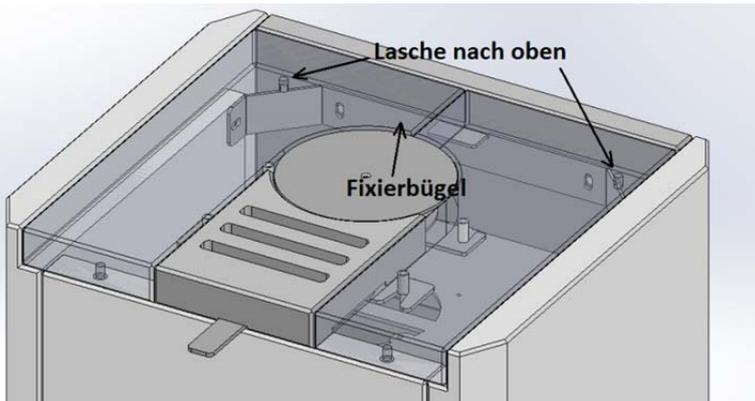
8. Linke und rechte Deckplattenhälfte Gewindesttift montieren anschliessend auflegen und Halterung für Konvektionsschieber montieren (Bild von unten)
