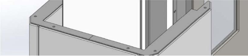
7. Bei der 4. Reihe Fixierbügel mit Lasche nach oben montieren
