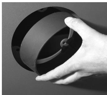
Installez l'ajutage pour le départ des fumées à l'arrière avec 3 vis à tête cylindrique M6x20 et des écrous M6.
