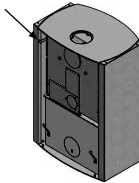
7. Das hintere Panel wieder montieren und die 4 St. mitgelieferten Stifte, 2 auf jeder Seite, einsetzen. Den Deckstein oben auf dem Ofen platzieren und darauf achten, dass die Stifte in den Seitensteinen in die Führungslöcher der Deckplatte greifen.
