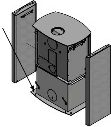
6. Den Seitenstein leicht zum Ofen hin drücken und den Fixierungsbeschlag ganz nach vorne ziehen, sodass der Beschlag einrastet. Jetzt sind die Steine verriegelt.
