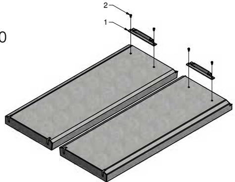
2. Die Fixierungsbeschläge in Bezug auf die Oberkante des Seitensteins wie auf dem Bild zu sehen ausrichten.
