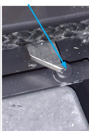
Les portes latérales peuvent maintenant être ouvertes pour nettoyer les vitres des portes. Les portes latérales se verrouillent à nouveau, dans l'ordre inverse. N'oubliez pas les 4 crochets de verrouillage et les deux arrêts de porte.
