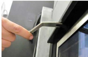
La porte latérale s'ouvre pour le nettoyage en faisant tourner le crochet de verrouillage en haut et en bas de la porte.
