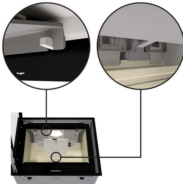
Retirez le déflecteur de fumée en le soulevant vers le haut et vers l'arrière pour le dégager des supports.
