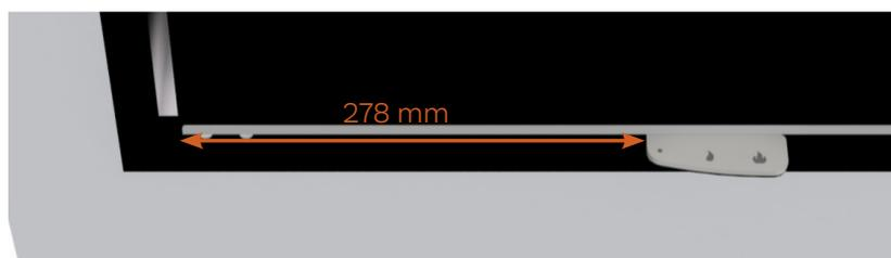
\*Le réglage précis de l'amortisseur entre la position centrale et la position fermée est de 278 mm entre le bord de la porte et le bord de la poignée de l'amortisseur..
