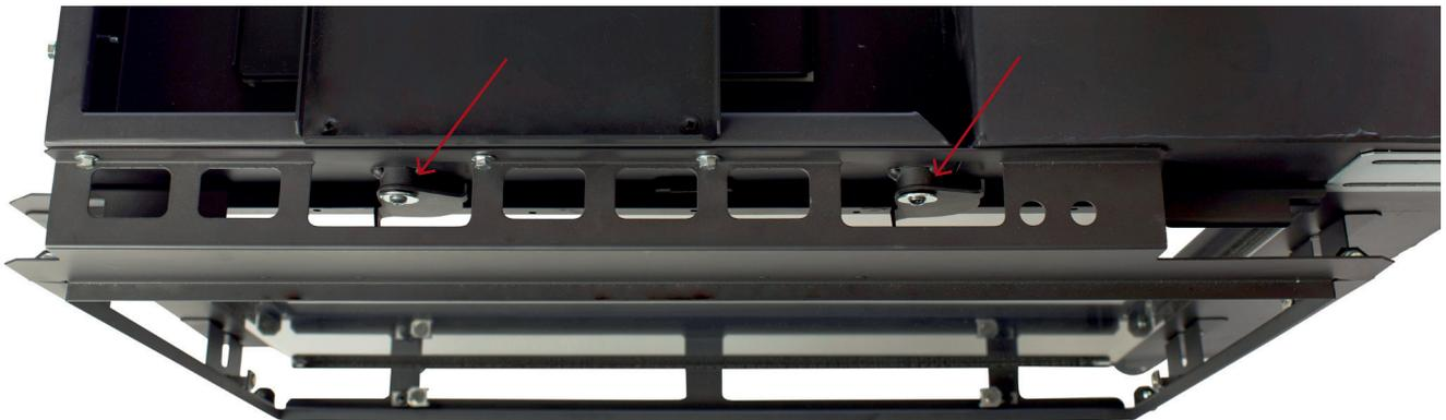
2. Drehen Sie die beiden drehbaren Klappen gegen den Uhrzeigersinn, bis sie sich vom Glas lösen.
