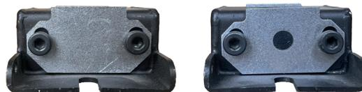
Die Venturis für die Sekundärbrenner müssen vollständig geöffnet sein, ohne dass Abdeckplatten installiert sind.
