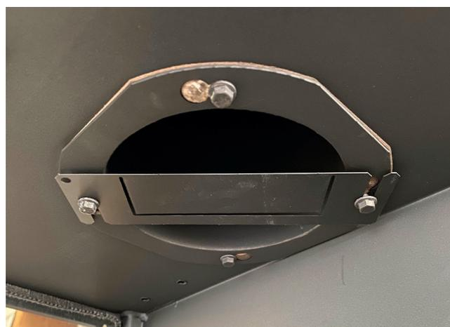
2. Montieren Sie den Begrenzer entsprechend der Form und ziehen Sie dann die beiden Schrauben über Kreuz an.
